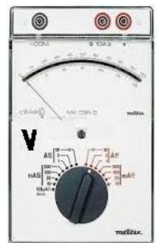
**Voltmètre numérique :** Avec sélecteur de fonction on choisit la fonction voltmètre sa mesure est positive lorsque le courant entre par la borne « + » (ou V) et sort par la borne « - » (ou « COM »).
